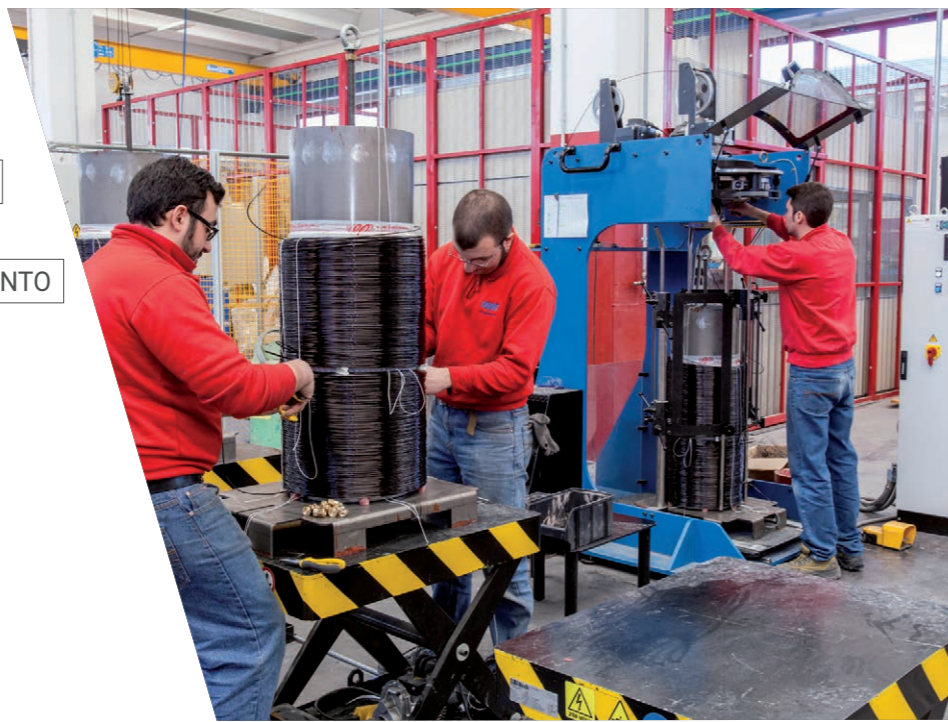
MÁQUINAS BOBINADORAS DE ÚLTIMA GENERACIÓN PARA LA REALIZACIÓN DE BOBINADOS AT/BT
